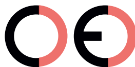
Marca CE falsa (demasiado separados)
